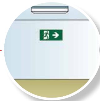
Skyltning av utrymningsväg
