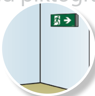
Riktningsändring i utrymningsväg
